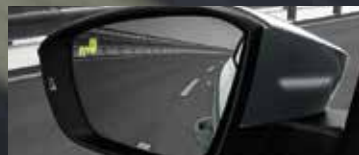
СИСТЕМА КОНТРОЛЯ СЛЕПЫХ ЗОН С АССИСТЕНТОМ ВЫЕЗДА С ПАРКОВКИ ЗАДНИМ ХОДОМ
