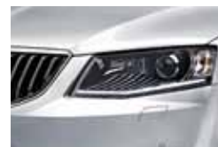
Биксеноновые фары со светодиодными ходовыми огнями
